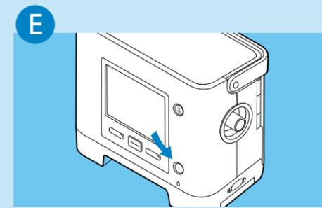
Pressione para operar o dispositivo ou continuar navegando pelo menu para configurar os parâmetros de ventilação
