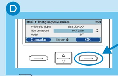
Use para escolher **PAP ativo** (configuração da válvula de expiração) ou **passivo** (configuração da porta de expiração) e, em seguida, pressione **OK** duas vezes para confirmar
